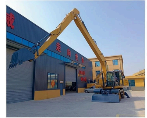
EXCAVADORA DE RUEDAS DE 24 TONELADAS con brazo extendido de 15 metros.
