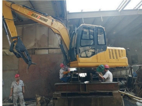
PINZA PARA TRONCOS MODELO 110 con fuente de alimentación fija y externa de 380 V
