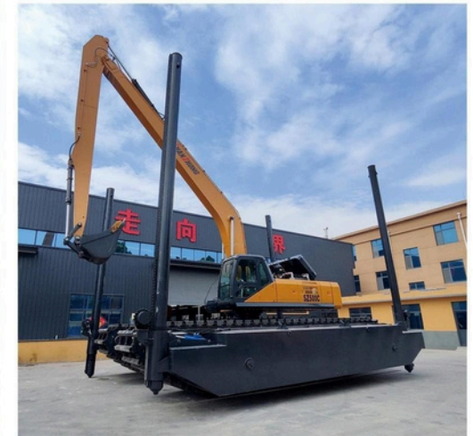
DRAGA DE 45 TONELADAS con pilotes de poscionamiento
