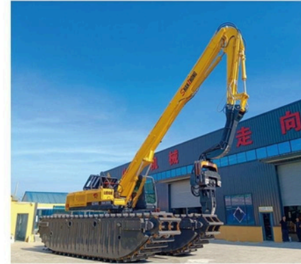
EXCAVADORA ANFIBIA MODELO 380 con pilotes de posicionamiento
