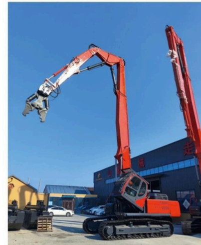
EXCAVADORA DE DEMOLICIÓN DE PLUMA de 3 secciones con estándar de emisiones Euro V 45 toneladas.
